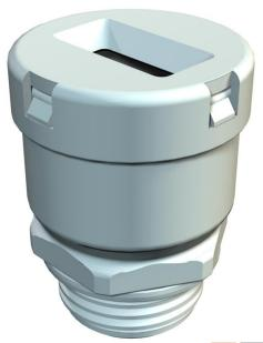
Prensaestopas para cables planos tipo racor estrangulador, con rosca de conexión métrica según IEC 432, grado de protección IP31, con anillo de sellado tipo 107/F premontado.
