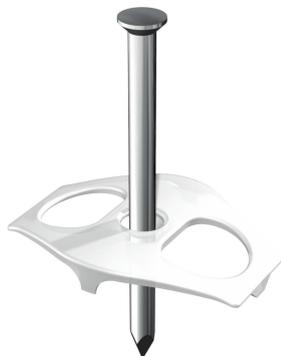
Con clavos de acero cincados premontados de Ø de 3 mm o de 3,5 mm para la fijación de conductores en rozas para 1 ó 2 conductores NYM 3 x 1,5/2,5 mm<sup>2</sup> o 1 ó. 2 conductores NYM 5 x 1,5/2,5 mm<sup>2</sup>.
