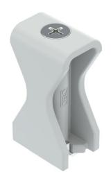
Versión para cargas pesadas, también adecuado para carriles con ancho de ranura de 16 ÷ 17 mm; cuerpo de abrazadera de poliamida, gris claro RAL 7035; piezas metálizas de acero, galvanizado en caliente.
