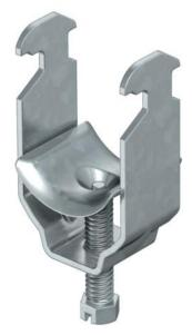
Adecuado para todos los perfiles en C con una ranura de 16 - 17 mm. Abrazadera, tornillo y media caña de acero galvanizado en caliente. Bajo demanda está disponibel la versión con tuerca de soldar y/o contratuerca para uso en condiciones difíciles o con riesgo de vibraciones.
