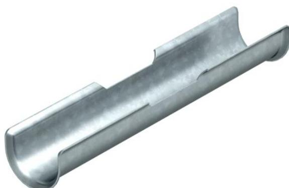
Para aumentar la superficie de apoyo de cables con mantenimiento de función integrado, se instala adicionalmente una mediacaña alargada (L = 200 mm) para la abrazadera sobre perfil.
