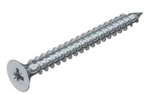
Acero endurecido, electrogalvanizado y con recubrimiento con Hostaflon (PTFE). Cabeza avellanada con ranura en cruz (destornillador tamaño 2, a excepción del  $\emptyset$  de 6 mm que es tamaño 3).
