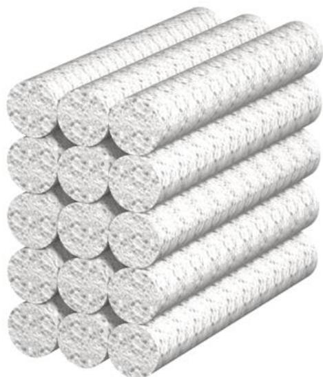
La barrera de insonorización sirve para reducir la transmisión de ruido aéreo, por ejemplo al conducir el sistema de canales a través de pasos de pared entre dos oficinas. La barrera insonorizada está formada por lana de vidrio que se suministra con un diámetro de unos 30 mm y una longitud de unos 300 mm. Las trenzas no necesitan estar extremadamente comprimidas al instalarlas. El aislamiento acústico es de unos 40 dB.
