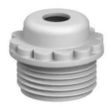
Con entrada de cable abierta. Junta de estrangulación para el roscado en roscas métricas según IEC 423. Con cono autosellante en el extremo de la rosca, por lo que no se requiere junta en la rosca de conexión.
