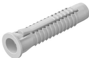
También se puede utilizar como taco para orificios huecos, posee un collarín para evitar que se deslice hacia dentro. Las 3 aletas que tiene absorben el par de giro.
