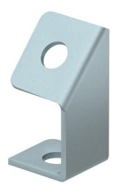
El componente de conexión es el elemento de unión para la disposición oblicua de la fijación de varillas roscadas en un montaje de pared de los tipos de instalación estándar con bandejas de escalera y bandejas portacables para el mantenimiento de función según DIN 4102, parte 12.
