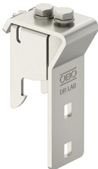
Piezas distanciadoras para el montaje de tapas en bandejas portacables de vano ancho y bandejas de escalera de vano ancho a distancia. Altura de distancia 35 mm, acero inoxidable 1.4301.
