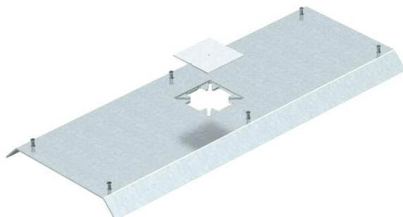
Tapa de tomas de corriente para la base del canal de derivación AIKA/U, para el montaje de una Telitank. La tapa del canal se atornilla a los perfiles laterales de aluminio de la base del canal. El bisel de la tapa cubre la base del canal por ambos lados formando un ángulo de 45°.
