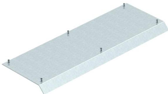
Tapa ciega para el canal sobre pavimento AIK, apropiada para las bases de canal AIK/U. La tapa se atornilla en los perfiles laterales de aluminio de la base del canal. El bisel de la tapa cubre la base del canal formando un ángulo de 45°.
