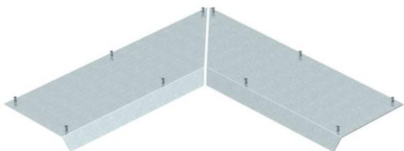
Tapa ciega de 2 piezas para la esquina interior de un canal sobre pavimento, adecuada para las bases de canal AIK/U, con 10 tornillos de fijación. La tapa del canal se atornilla a los perfiles laterales de aluminio de la base del canal. El bisel de la tapa cubre la base del canal formando un ángulo de 45°.
