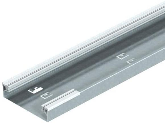
Base de canal sobre pavimento, de un solo conducto, para tapas ciegas o de montaje biseladas por un lado, con perfiles laterales de aluminio para apoyar y fijar la tapa del canal. Dispone de bridas de sujeción para un máximo de 2 paredes separadoras encajables y con conexión conductora y de troquel para una toma de tierra. La altura del canal es apropiada para el montaje de unidades Telitank.
