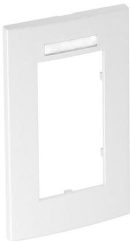
Tapa de fijación frontal para mecanismos Modul 45, doble, con campo identificativo, para la instalación vertical de mecanismos, se encaja en la caja portamecanismos 71GD13 o en el soporte de montaje 71MT2 45. Para la instalación en canales portamecanismos Rapid 80 y columnas de instalación eléctrica ISS.
