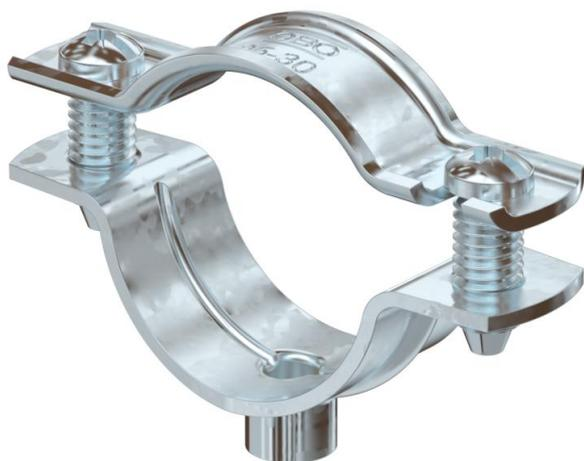
Abrazadera para el montaje de tubos y cables en la pared, el techo y el suelo. Con tapa autoblocante. Fijación a través de inserción con rosca interior. Superficies G y T a partir de tamaño de abrazadera 20 apropiado para el montaje con pistolas clavadoras y pistolas de pernos.
