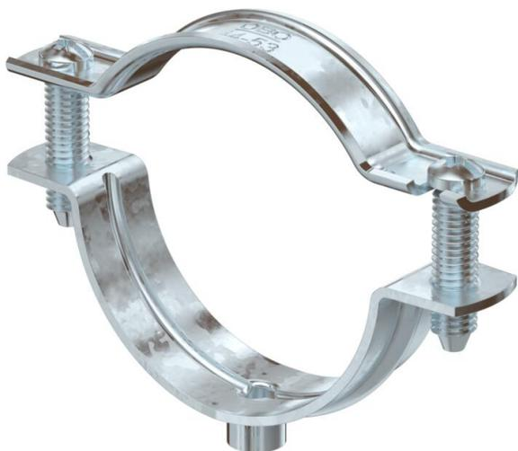
Abrazadera para el montaje de tubos y cables en la pared, el techo y el suelo. Con tapa autoblocante. Fijación a través de inserción con rosca interior. Superficies G y T a partir de tamaño de abrazadera 20 apropiado para el montaje con pistolas clavadoras y pistolas de pernos.
