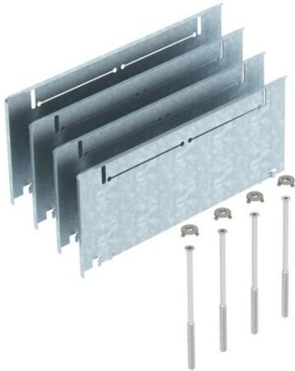
Kit de montaje para compensación de altura para cajas bajo suelo UZD250-3 con una altura de instalación de 115 a 170 mm para elevar la UZD in situ a una altura de 165-220 mm, compuesto por 4 placas de caída, 4 tornillos de nivelación y 4 cierres giratorios.
