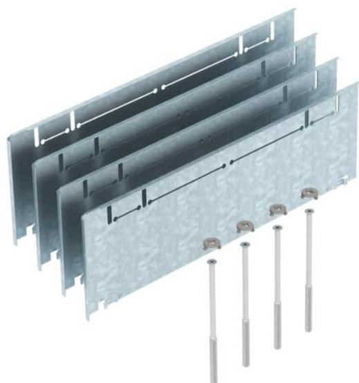
Kit de montaje para compensación de altura para cajas bajo suelo UZD350-3 con una altura de instalación de 165 a 220 mm para elevar la UZD in situ a una altura de 215-270 mm, compuesto por 4 placas de caída, 4 tornillos de nivelación y 4 cierres giratorios.
