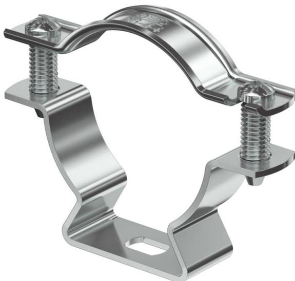
Abrazadera para el montaje de tubos y cables en la pared, el techo y el suelo. Con tapa autobloqueante. Fijación a través de agujero alargado. A partir de tamaño de abrazadera 20 apropiado para el montaje con pistolas clavadoras y pistolas de pernos.
