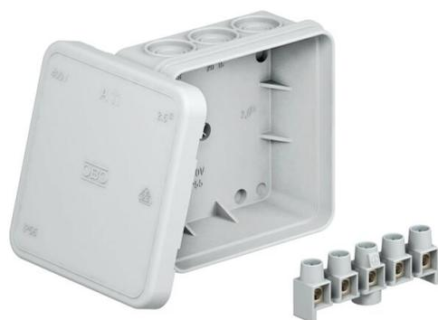
Grado de protección IP55, tensión nominal de 690 V, sección nominal de 2,5 mm<sup>2</sup>, 12 entradas para diámetro de cable de 5-14 mm.
