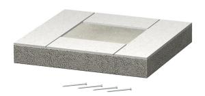
Pieza final para canal de protección contra el fuego PYROLINE® Con D BSK 190/E30 compuesto por hormigón ligero con fibra de vidrio, resistente al agua y a las heladas para cerrar los extremos de cables.
