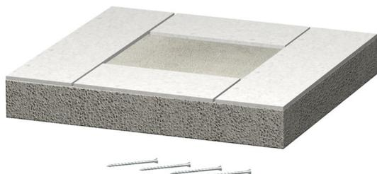
Pieza final para canal de protección contra el fuego PYROLINE® Con D BSK I90/E30 compuesto por hormigón ligero con fibra de vidrio, resistente al agua y a las heladas para cerrar los extremos de cables.
