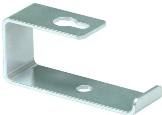
Taco de separación como ayuda de instalación en caso de montaje del canal de protección contra el fuego PYROLINE® Con D BSK, tipo BSK 090521 y tipo BSK 120521. Montaje del soporte directamente en los tacos de fijación del canal de protección contra el fuego.
