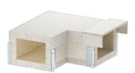
Curva de 90° para conducto de protección contra incendios PYROLINE® Con S BSK 190/E30, compuesto por hormigón ligero de fibra de vidrio resistente al agua y las heladas, para la creación de cambios horizontales de dirección del conducto. Los conectores montados aseguran un montaje rápido in situ, mientras que las cubiertas colocadas sin apretar garantizan una inspección y reasignación rápidas.
