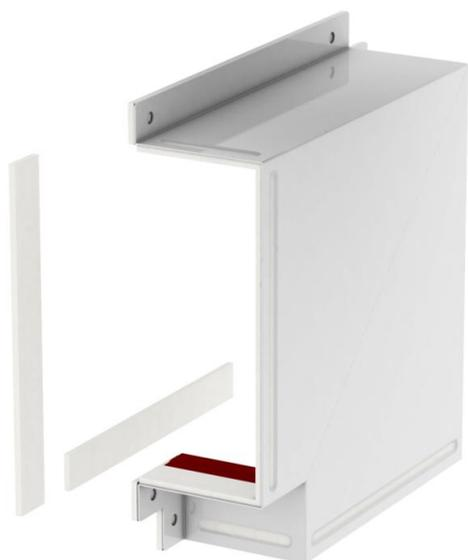
Tapa para la cubierta de dos extremos de canal BSKM 1025 para ángulo exterior con montaje directo a pared y techo. Incluidas juntas adheridas para el sellado de ranuras y juntas sueltas en combinación con contraplaca, así como tornillos para la conexión equipotencial.
