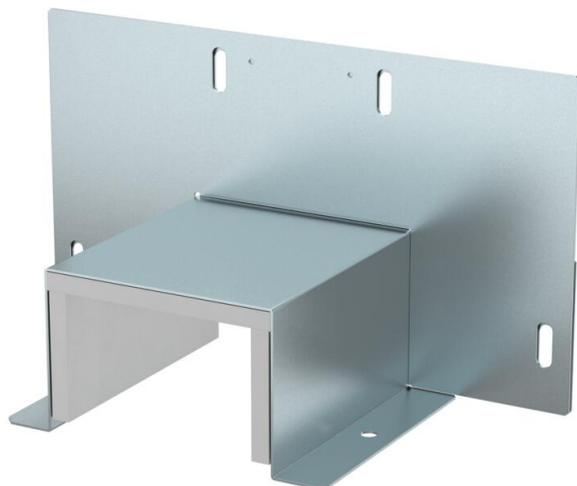
Marco como aislamiento adicional en la zona de intersección de la pared en caso de montaje directo de BSKM 0711 en la pared o en el techo. Incluidos embellecedor y juntas para el sellado de ranuras y junta suelta en combinación con contraplaca, así como tornillo para la conexión equipotencial.
