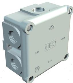
Grado de protección IP54, tensión nominal 660 V, sección nominal 2,5 - 4 mm<sup>2</sup>, en combinación con el bloque de bornes 700/6 M la caja tiene una sección nominal de 4 mm<sup>2</sup>, 2 orificios de fijación para tornillos de hasta 5 mm de Ø en el lado exterior de la caja. 4 tornillos de tapa, 7 Entradas rompibles con rosca M20 x 1,5, preferiblemente para prensaestopas con rosca de conexión corta.
