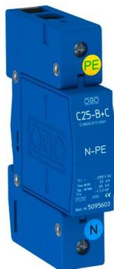
Vía de chispas integrada enchufable para la instalación entre el conductor neutro (N) y el conductor de protección a tierra (PE). Puede utilizarse en combinación con: • CombiController V 25-B+C • SurgeController V 20-C
