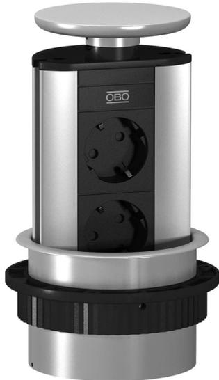
Deskbox extraíble con cable de conexión, para el montaje fijo en un tablero de mesa, manguito de unión de plástico, lacado en el mismo color que la tapa. El montaje se realiza perforando un orificio (102 mm Ø) en el tablero de la mesa.
