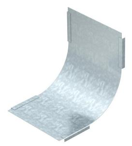
Tapa para todas las curvas verticales ascendentes. La fijación queda garantizada mediante la solapación de la tapa a la bandeja portacables. De forma adicional, la tapa puede fijarse con las grapas.
