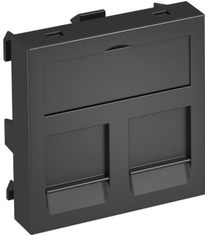
Soporte de datos con salida recta y deslizante de cierre para alojar dos módulos de conexión de datos con toma RJ45. Se puede instalar tanto vertical como horizontalmente. El tipo RM tiene un módulo receptor especial y está diseñado para una fijación indirecta de los módulos de conexión de datos en la abertura de montaje.
