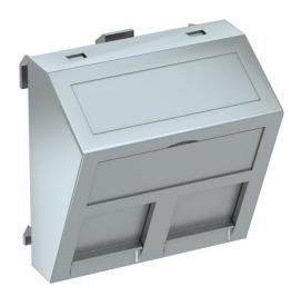
Soporte de datos con salida transversal y deslizante de cierre para alojar dos módulos de conexión de datos con toma RJ45. Se puede instalar tanto vertical como horizontalmente. El tipo A tiene una abertura de montaje de 20,10 x 14,80 mm y está diseñado para la fijación directa de los módulos de conexión de datos en la abertura de montaje.
