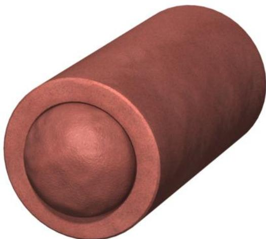
Cubierta de tubos para aislamiento de cable consistente en un collarín para tubo duro de una sola pieza y dos tapones blandos de 50 mm de diámetro. Proteger del agua el collarín para tubo y los tapones para garantizar una correcta expansión de la espuma en caso de incendio. Uso en interiores.
