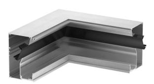
Parte inferior del ángulo interior para la creación de un canal portamecanismos de diseño de la serie GAD. Abertura de sistema de 45 mm para montar equipos de conmutación y conexión Modul 45 y sus tapas correspondientes de PVC y aluminio de la serie Rapid 45. La pieza preformada puede completarse con cubiertas de diseño "Swing", "Soft" o "Style" Son obligatorios los adaptadores de tapa GAD OTA. Entre las cubiertas del canal debe insertarse una pieza distanciadora GAD OTD.
