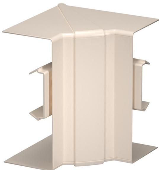
Tapa para ángulo interior de PC/ABS sin halógenos para cambio de dirección del canal portamecanismos Rapid 80 de los sistemas GK, GKH, GS y GA. El ángulo exterior puede ajustarse entre 85° - 95° y se puede utilizar con canales simétricos y asimétricos.
