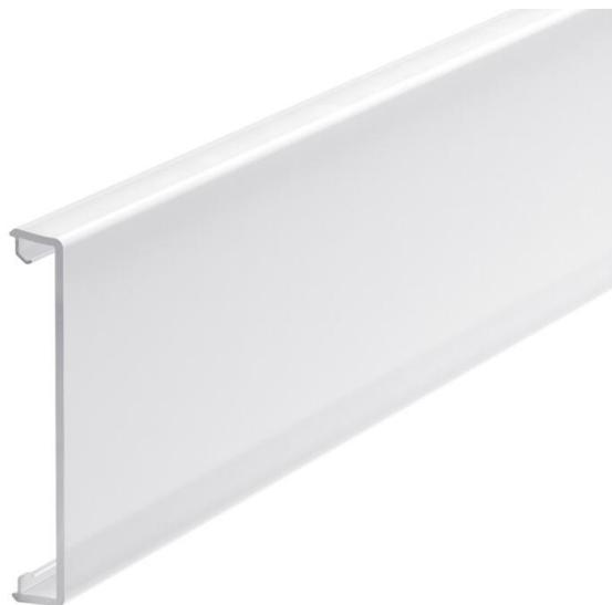
Tapa de canal para cierre de canales portamecanismos Rapid 80 GK (PVC), GS (acero), GA (aluminio) y columnas de distribución ISS con abertura de 76,5 mm. La tapa GK-OTGO está fabricada en un material PC transparente y blanco lechoso (estética: vidrio tallado) y es adecuado también para la integración de la iluminación en los canales y columnas. En plástico.
