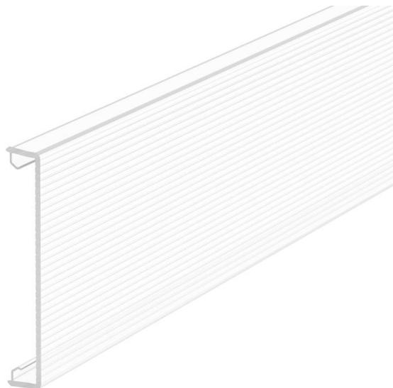
Tapa de canal para cierre de canales portamecanismos Rapid 80 GK (PVC), GS (acero), GA (aluminio) y columnas de distribución ISS con abertura de 76,5 mm. La tapa GK-OTKKP está fabricada en un material PC claro y transparente, y está canalizada en la parte interior (acanaladuras longitudinales) y es adecuado también para la integración de la iluminación en los canales y columnas. En plástico.
