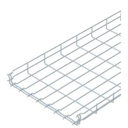
Bandeja de rejilla con conexión de unión rápida de ala 55 mm. Para la bandeja de rejilla no se necesitan componentes adicionales, simplemente se engancha la una con la otra. El ancho de malla es de 50 x 100 mm (excepción GRM 55/50 = 20 x 100 mm). Aislamiento magnético sin tapa 15 dB, con tapa 25 dB.
