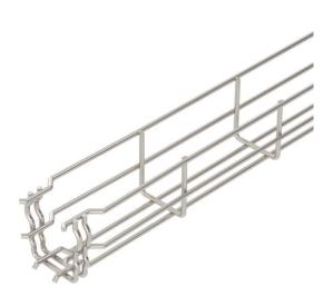
Bandeja de rejilla con conexión de unión rápida de ala 55 mm. Para la bandeja de rejilla no se necesitan componentes adicionales, simplemente se engancha la una con la otra. El ancho de malla es de 50 x 100 mm (excepción GRM  $55/50 = 20 \times 100$  mm). Aislamiento magnético sin tapa 15 dB, con tapa 25 dB.
