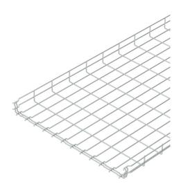
Bandeja de rejilla con conexión de unión rápida con ala de 55 mm. Para la bandeja de rejilla no se necesita ningún tipo de unión, simplemente se engancha un tramo con otro. El ancho de malla es de  $50 \times 100 \text{ mm}$  (excepción GRM  $55/50 = 20 \times 100 \text{ mm}$ ).
