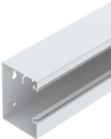
Canal portamecanismos GS para el montaje directo en la pared o en consolas de fijación. El canal portamecanismos GS dispone de unas pestañas en su base para colocar el tabique separador. La conexión equipotencial entre las bases de dos tramos de canal está garantizada gracias a las uniones. La conexión equipotencial entre la tapa y el cuerpo del canal está garantizada. La abertura del sistema mide realmente 76,5 mm. La tapa se debe pedir por separado.
