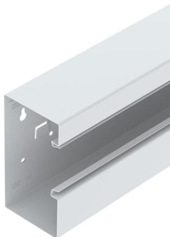
Canal portamecanismos GS para el montaje directo en la pared o en consolas de fijación. El canal portamecanismos GS dispone de unas pestañas en su base para colocar el tabique separador. La conexión equipotencial entre las bases de dos tramos de canal está garantizada gracias a las uniones. La conexión equipotencial entre la tapa y el cuerpo del canal esta garantizada. La abertura del sistema mide realmente 76,5 mm. La tapa se debe pedir por separado.
