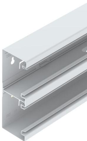
Canal portamecanismos GS para el montaje directo en la pared o en consolas de fijación. El canal portamecanismos GS dispone de unas pestañas en su base para colocar el tabique separador. La conexión equipotencial entre las bases de dos tramos de canal está garantizada gracias a las uniones. La conexión equipotencial entre la tapa y el cuerpo está asegurada al colocar la tapa. La abertura del sistema mide realmente 76,5 mm. La tapa se debe pedir por separado.
