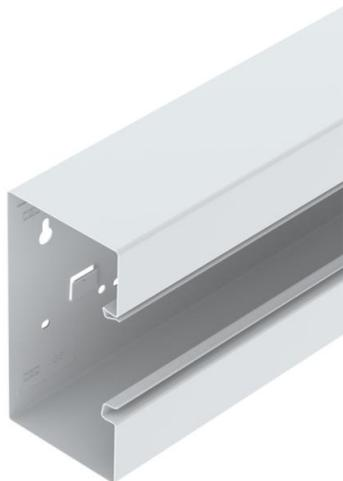
Canal portamecanismos GS para el montaje directo en la pared o en consolas de fijación. El canal portamecanismos GS dispone de unas pestañas en su base para colocar el tabique separador. La conexión equipotencial entre las bases de dos tramos de canal está garantizada gracias a las uniones. La conexión equipotencial entre la tapa y el cuerpo del canal está garantizada. La abertura del sistema mide realmente 76,5 mm. La tapa se debe pedir por separado.
