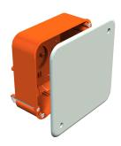
Caja de conexión para paredes huecas, 20 aberturas rompibles para conductores NYM, líneas de datos y tubos Ø 20 mm, con tapa y tornillos de tapa, con tapa blanca y tornillos de tapa (retardante a la llama según VDE 0471/DIN 695 parte 2-1, temperatura de ensayo 750 °C), para placas con un grosor de 7-35 mm. Con tapa y tornillos para tapa Adecuadas para el montaje de carriles normalizados (carriles DIN y perfiles) para regletas de bornes, grado de protección .
