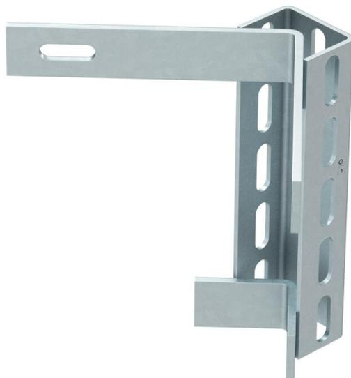
Complemento para esquina con perfil en U soldado para una fijación en ángulos exteriores de 90°. En el perfil se atornilla la escuadra de pared/perfil.
