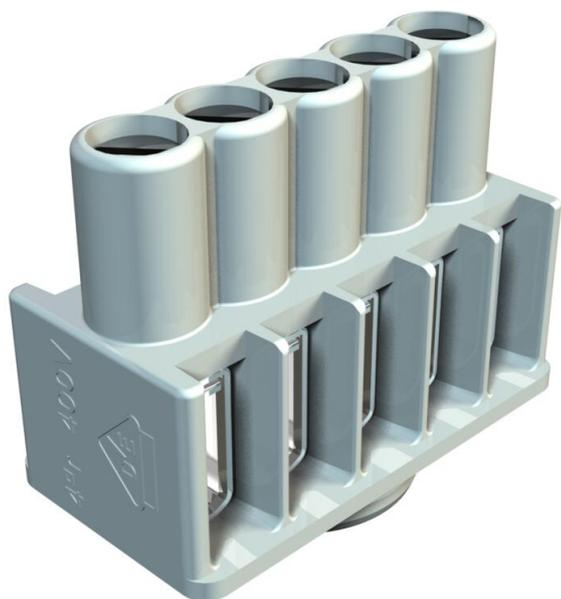
Cuerpo y tornillos de acero galvanizado y pasivado transparente, sección nominal 1 ÷ 4 mm<sup>2</sup>, tensión nominal 400 V, de 5 polos, con bornes de casquillo, sección máxima que se puede conectar en cada borne máx. 4x2,5mm<sup>2</sup>, 5x1,5mm<sup>2</sup> o 6x1mm<sup>2</sup>.
