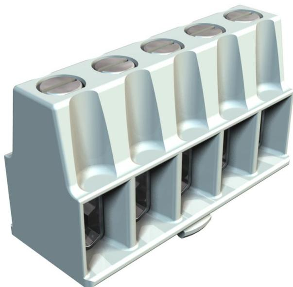
Cuerpo y tornillos de acero galvanizado y pasivado transparente, sección nominal 1,5 ÷ 6 mm<sup>2</sup>, tensión nominal 400 V, de 5 polos, con bornes de casquillo, sección máxima que se puede conectar en cada borne: 3x6mm<sup>2</sup>, 4x4mm<sup>2</sup> o 6x2,5mm<sup>2</sup>.
